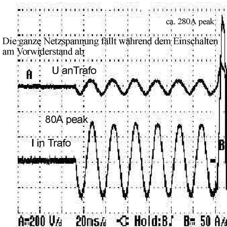
Das Relais im Einschaltstrombegrenzer wurde bei diesem Schaltversuch beschädigt. Der zusätzlich vorgeschaltete C16A Automat hat nach dem Brücken mit ausgelöst. Das Relais im Einschaltstrombegrenzer hat beim nächsten Einschaltversuch den Widerstand nicht mehr gebrückt, worauf dieser verbrannt ist.
