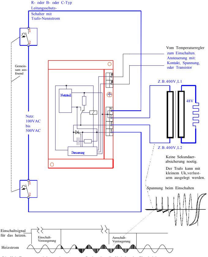
Die Heiz-Temperatur wird von einem externen Regler über die Variation der Einschaltdauer gesteuert. Der TSRL hat eine Einschaltverzoegerung von ca.50msec. und eine Ausschaltverzögerung von ca. 60msec.
