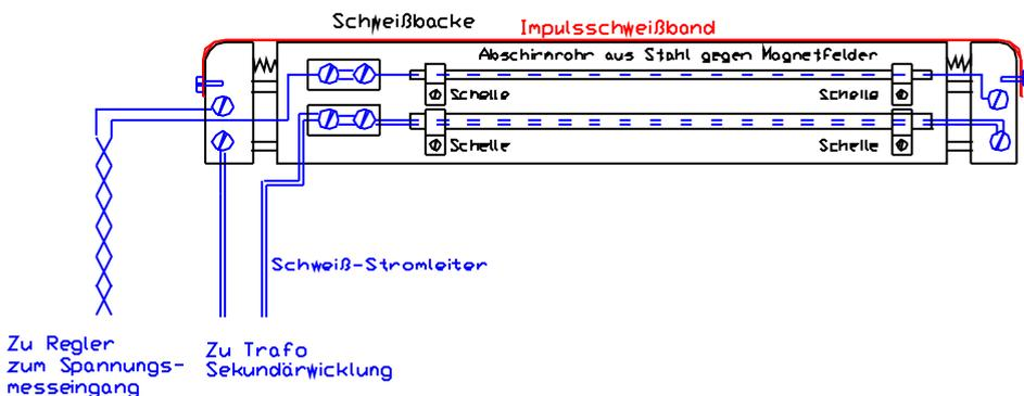
3. Verbesserung für Verdrahtung von Impulsschweißbacke, separate Abschirmung für Strom und Messleiter
