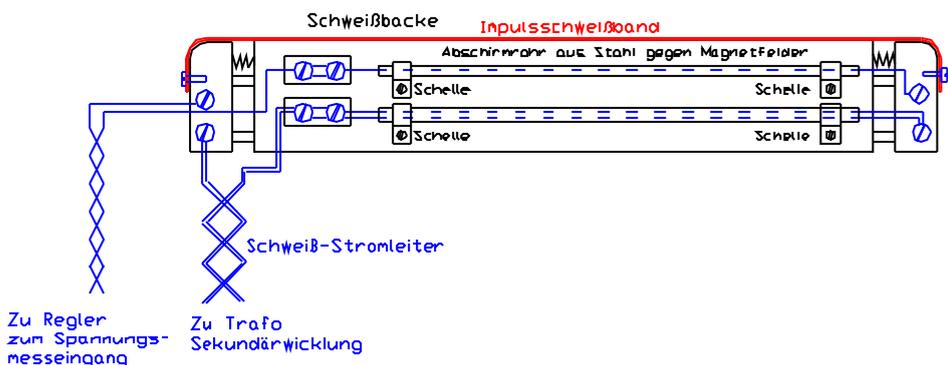
4. Verbesserung für Verdrahtung von Impulsschweißbacke, wenn mehrere Regler pro Maschine, wie 3. jedoch zusätzlich verdrehte Stromleiter
