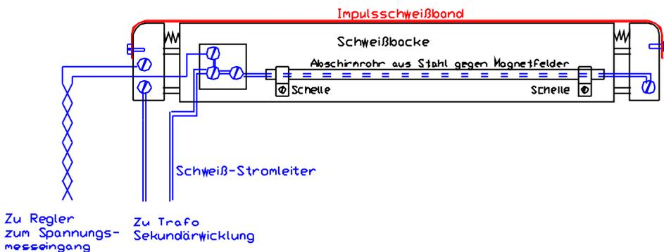
2. Verbesserung für Verdrahtung von Impulsschweißbacke, Stromleiter abgeschirmt
