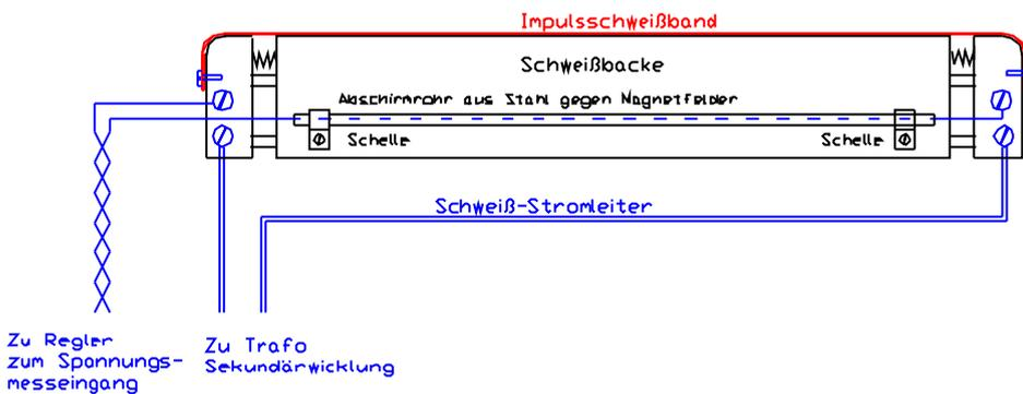
1. Verbesserung für Verdrahtung von Impulsschweißbacke, Messleiter abgeschirmt
